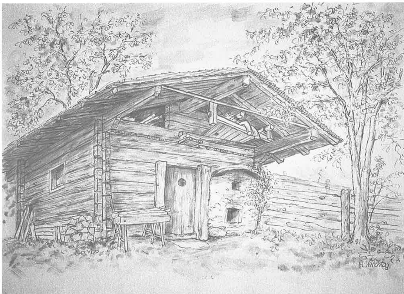
21 Das alte Brechlbad beim Hoisenbauern am Unkenberg. Die Heizöffnung des Hinterladerofens befindet sich hier ausnahmsweise auf der Giebelseite.
